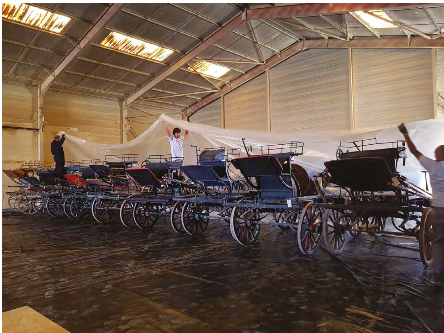
Les véhicules hippomobiles des Haras nationaux placés sous bulle hermétique en vue du traitement par fumigation.
