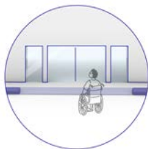
Bateau ou abaissement de trottoir
